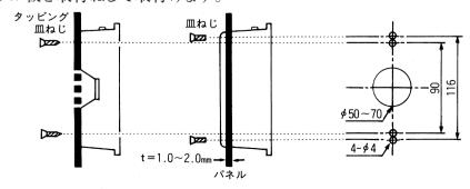
図2. 埋込み取付図
