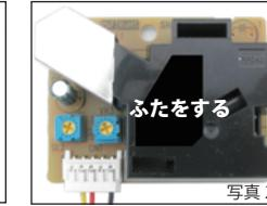
内部に熱源があり、熱による対流で外部の空気を吸い込み、上部から排出する機構になっています。
